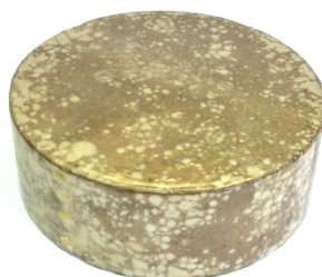
Рис. 15. Грунтовый образец обработанный парафином Далее образцы помещали в стальную форму (рисунок 16).
