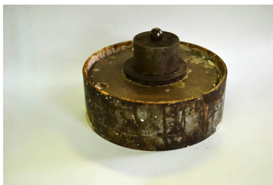
Рис. 17. - Грунтовый образец в стальной форме бокового обжатия с приложенным штампом
